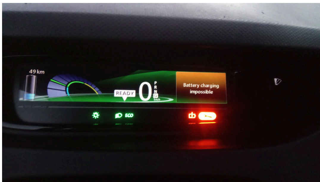
Slika 12: Prikaz napake pri polnjenju električnega vozila Renault Zoe (Lastni vir)
