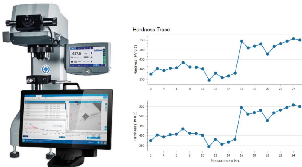
Slika 9: Merilnik mikrotrdote Wilson VH1202 (Lastni vir)
