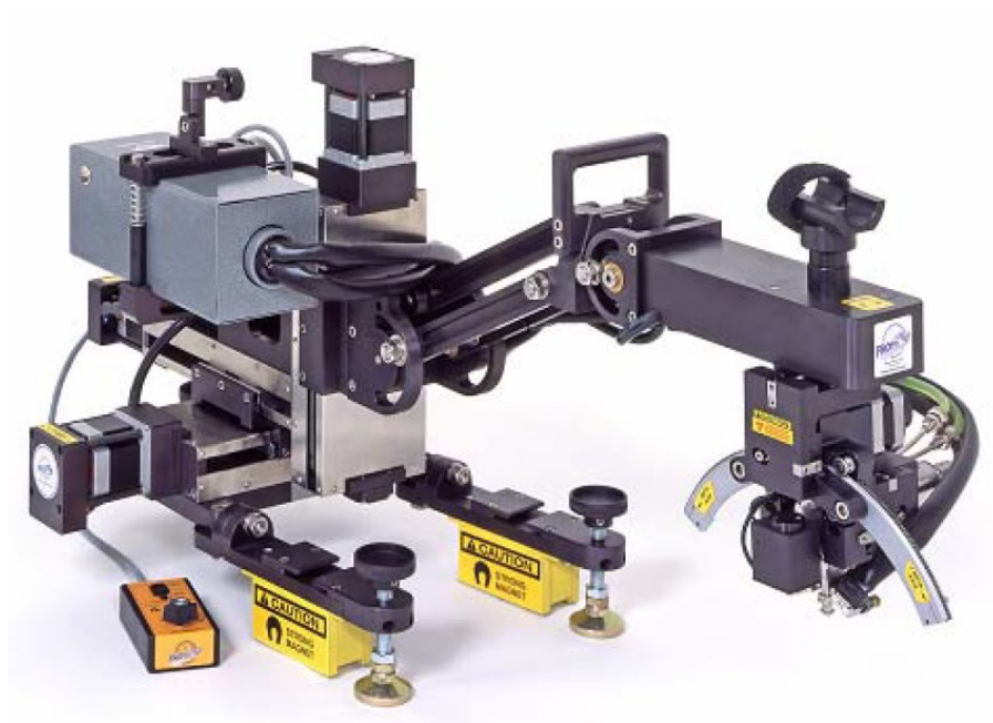
Slika 15: Naprava za merjenje zaostalih napetosti po XRD metodi (Lastni vir)
