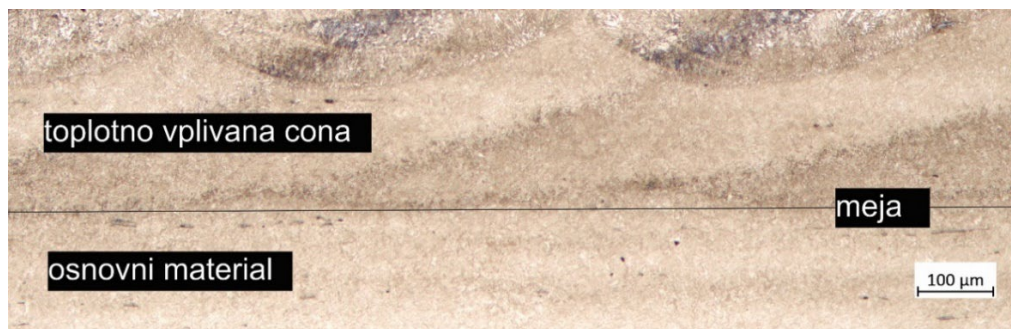
Slika 22: Mikrostruktura navarjenega sloja pri 100 x povečavi (Lastni vir)
