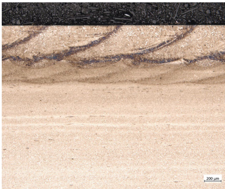
Slika 23: Mikrostruktura navarjenega in brušenega sloja pri 50 x povečavi (Lastni vir)
