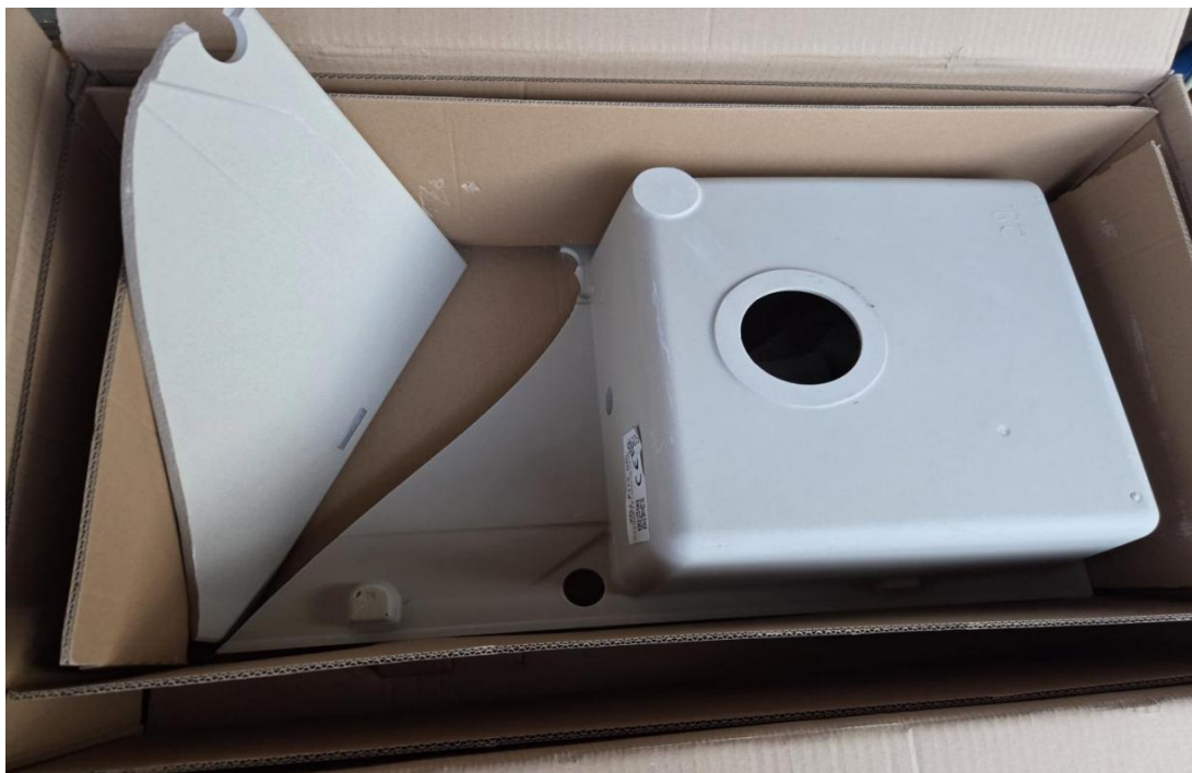
Slika 3: Primer poškodovanega pomivalnega korita (Lastni vir)
