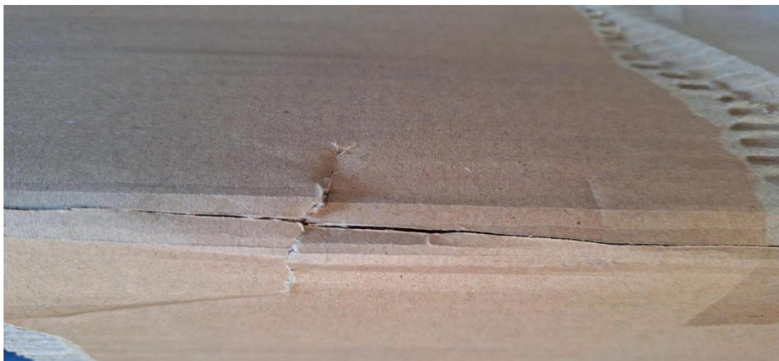
Slika 5: Prikaz poškodbe na zunanji embalaži izdelka (Lastni vir)
