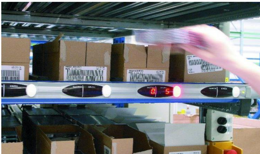
Slika 13: "pick-by-light" tehnologija (Vir: Zupančič in Perme, b. l.)
