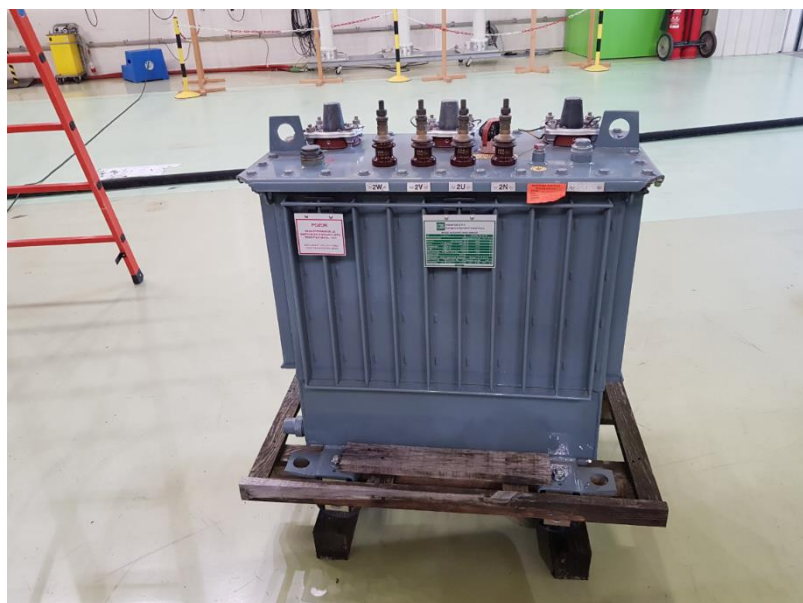
Slika 38: Transformator Yzn5, 50 kVA, 20/0,4 kV, (Vir: lastni)
