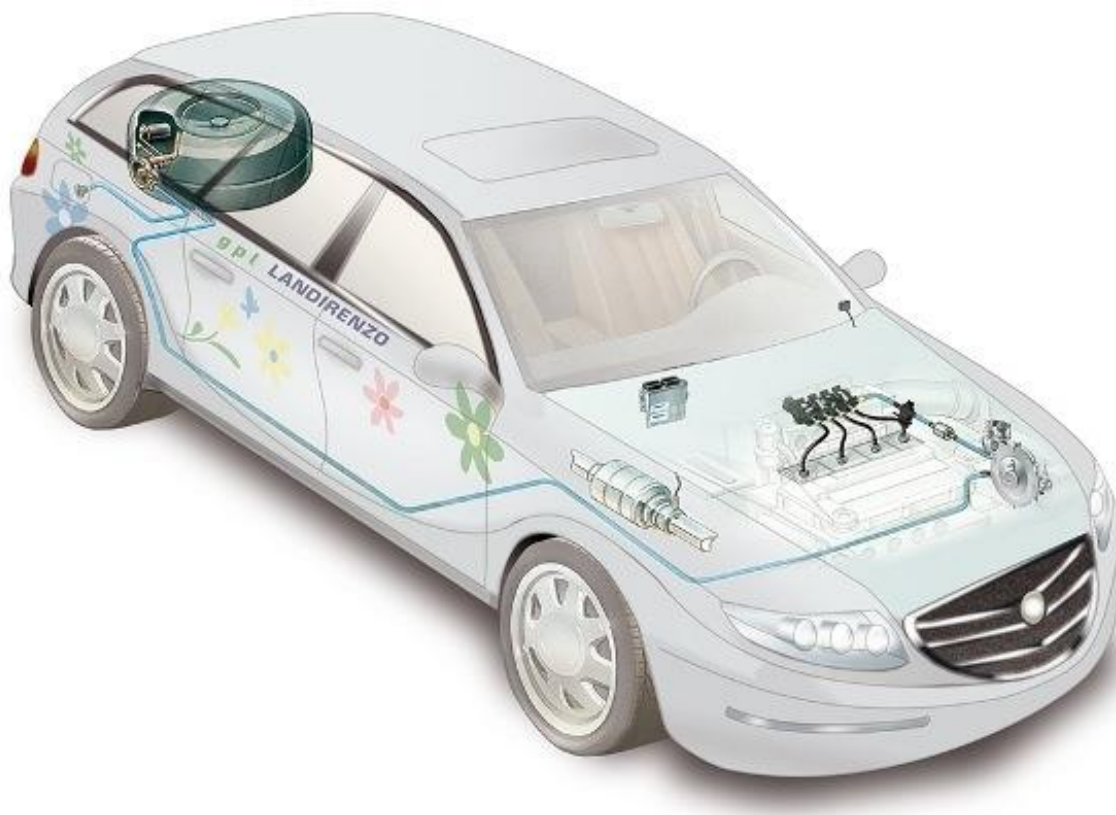
Slika 2: Plinska instalacija v avtomobilu (Vir: www.avtoplin.info , 2017)
