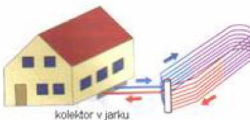
Slika 20: Zemeljski kolektor v zbiralnem jarku (Vir: Arhem d.o.o, 2021) 13
