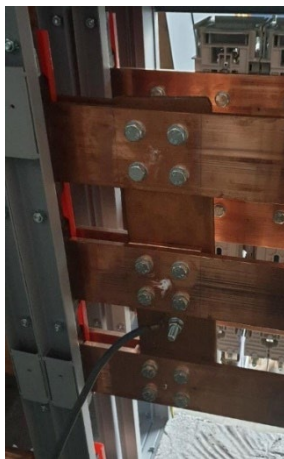
Slika 33: Kratek stik v točki SC1 (Vir: Končar test report številka 35/6807, 2022)
