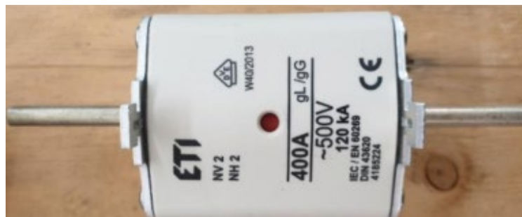
Slika 26: Talilni varovalni vložek uporabljen na testu (Vir: Končar test report številka 35/6807, 2022)
