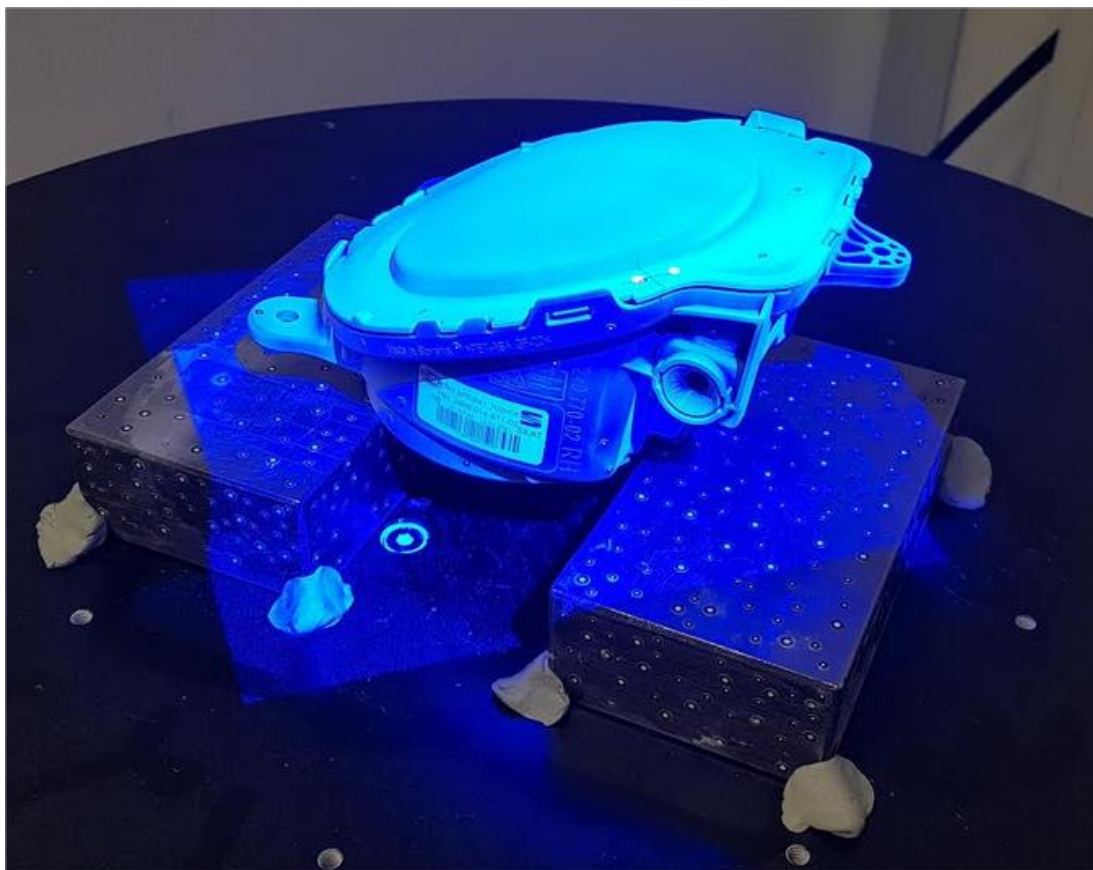
Slika 31: Meglenka ob poteku skeniranja (Vir: Lastni)
