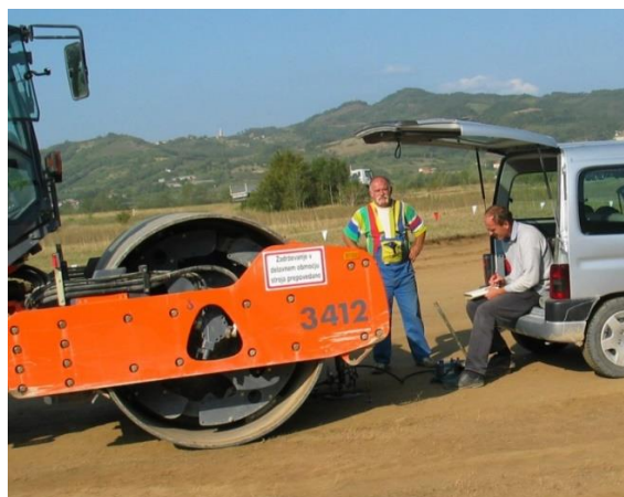
Slika 18: Meritev nosilnosti planuma temeljnih tal s krožno ploščo, poleg je valjar HAMM 3412.
