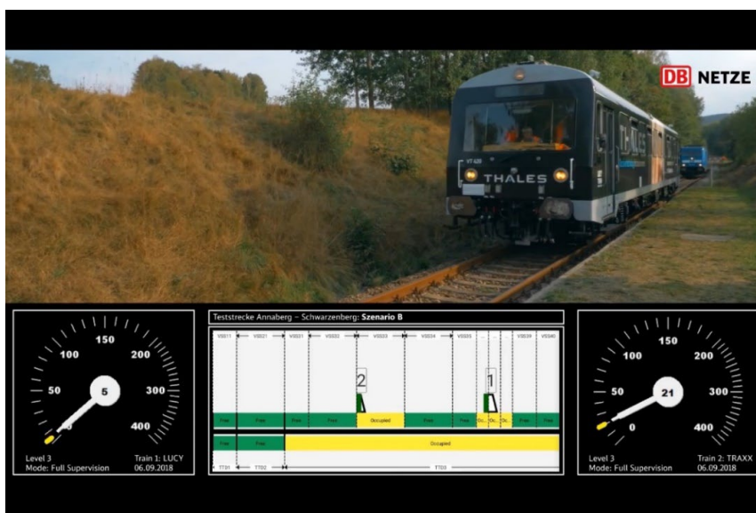
Slika 9: Testiranja ETCS-ja Level 3 na testni progi Annaberg–Schwarzenberg (Vir: DB Netz GmbH, 2018b)
