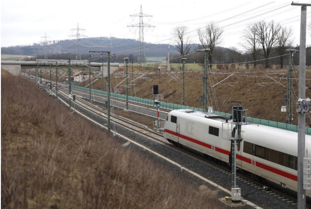
Slika 4: Primer proge, opremljene z ETCS Level 2 in ohranjenim sistemom PZB/Indusi ob svetlobni signalizaciji KS (Vir: Störfix, 2018)
