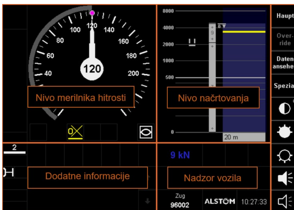
Slika 5: Osnovni prikaz na DMI monitorju (Vir: ÖBB Produktion GmbH, 2017a)
