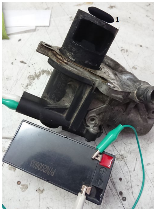
Slika 31: Preizkus električnega dela ventila EGR (Lastni vir)
