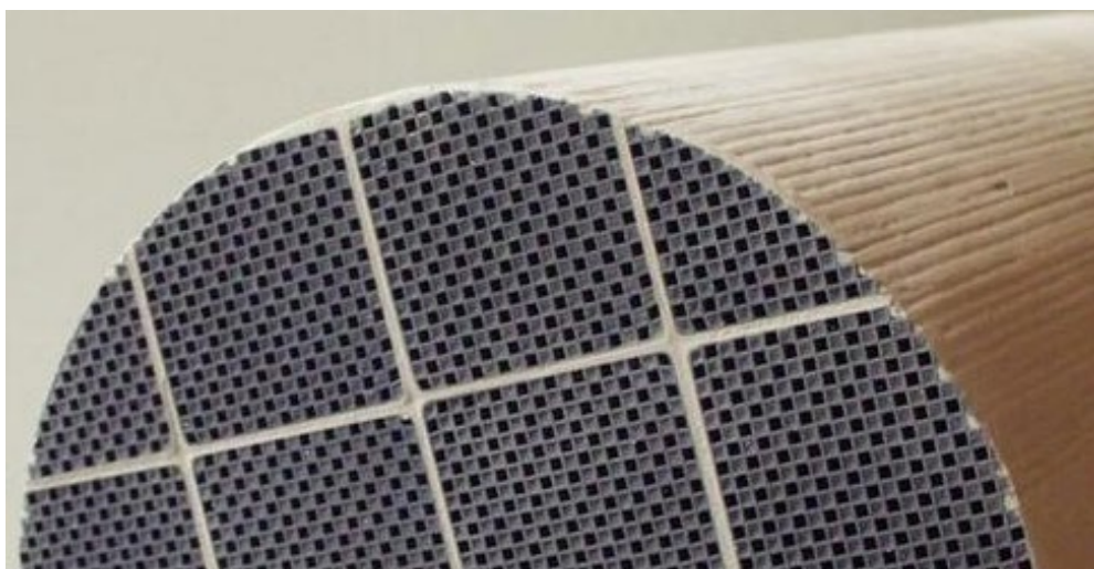
Slika 40: Monolitna zgradba filtra DPF (Vir: Otomatic portal, 2025) 28
