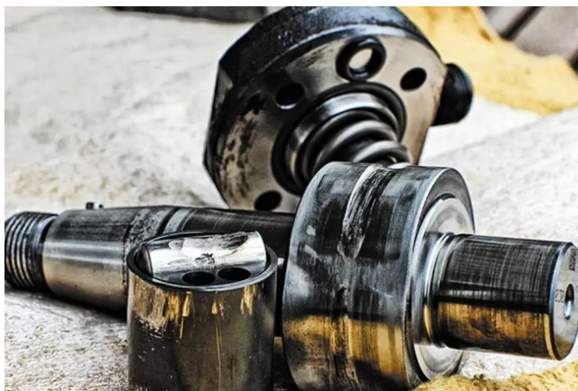
Slika 26: Poškodovan valjček in odmikač (Vir: Dieselworldmag portal, 2021) 23
