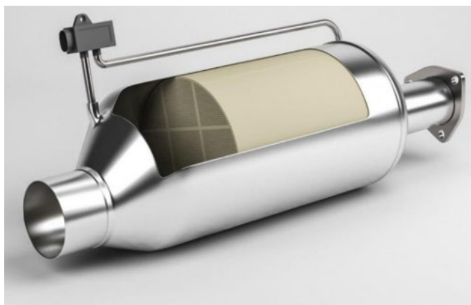
Slika 44: Filter DPF z zaznavalom diferenčnega tlaka (Vir: Diva portal, 2022) 32
