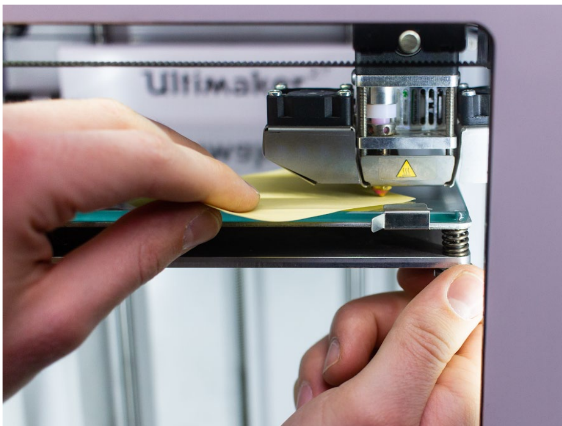
Slika 6: Nivelacija grelne plošče (Vir: MatterHackers, 2021)
