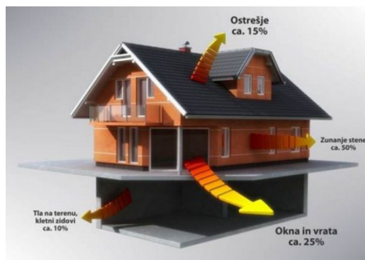
Slika 17: Toplotne izgube skozi stene objekta (Vir: Energetska izkaznica stavbe, 2025)
