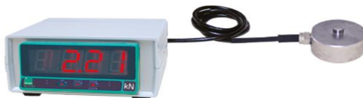
Slika 15: Primer uporabljenega silomera, proizvajalca Burster (Vir: Burster, 2021)
