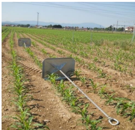
Slika 16: Sidro za navadno zemljo (Lastni vir)
