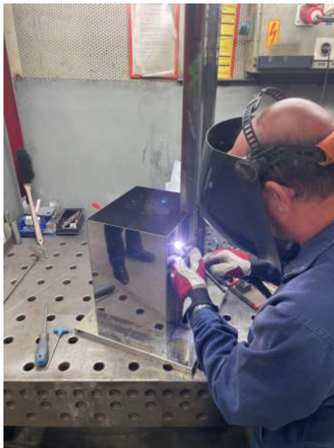
Slika 18 Varjenje komponent v glavni del razkuževalne enote (Lastni vir)
