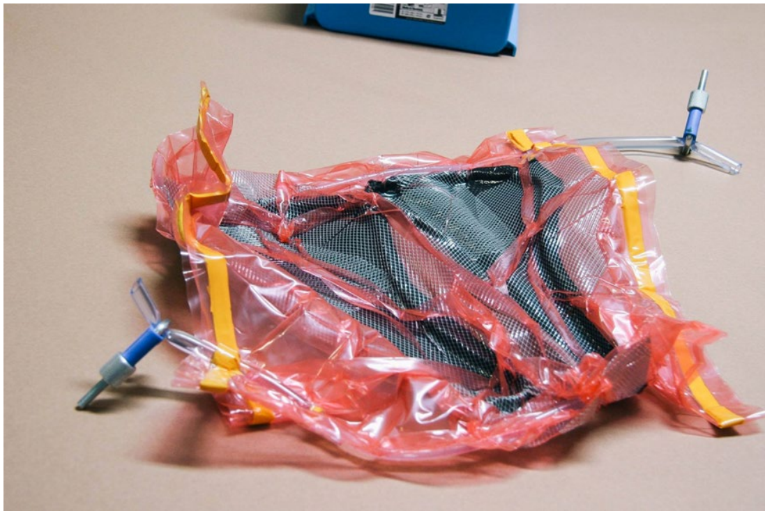
Slika 9: Kalup za izdelavo iz ogljikovih vlaken po postopku vakuumske infuzije (Lastni vir)
