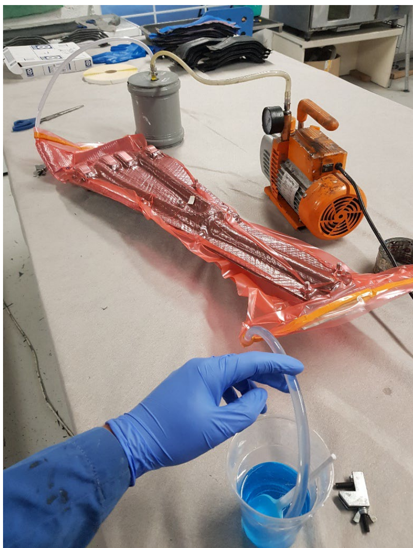
Slika 13: Postopek vakuumske infuzije cevastega profila (Lastni vir)
