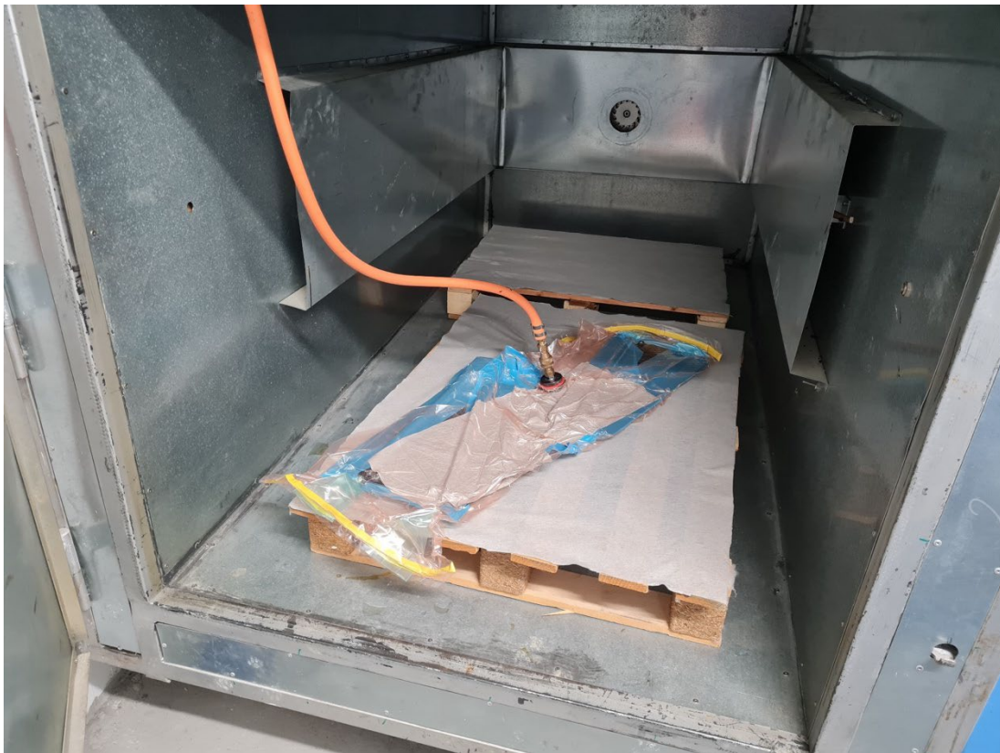
Slika 16: Primer temperaturnega utrjevanja v peči (Lastni vir)
