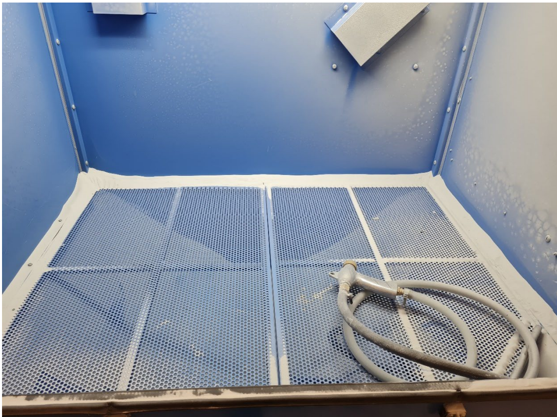
Slika 23: Peskalna komora (Lastni vir)
