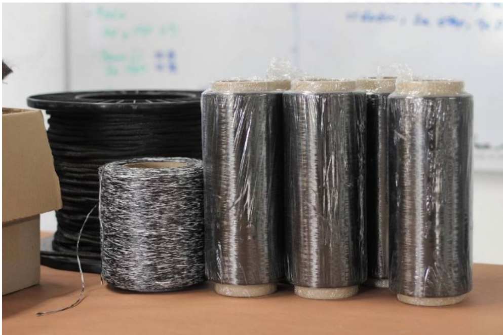
Slika 2: Ogljikova vlakna na kolotu (Lastni vir)
