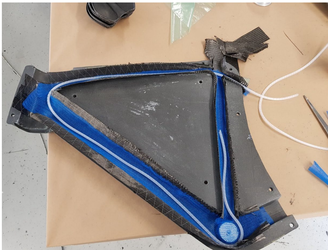
Slika 14: Ogljikova vlakna v kalupu s spiralno cevjo in polipropilensko mrežo za prenos epoksi smole po izdelku (Lastni vir)
