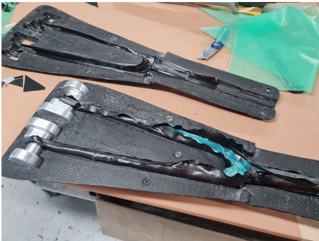
Slika 10: Ogljikova vlakna v kalupu brez medija za prenos smole (Lastni vir)
