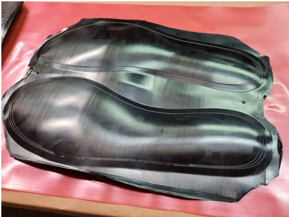
Slika 20: Primer izdelanega notranjika s postopkom prešanja kompozita (Lastni vir)
