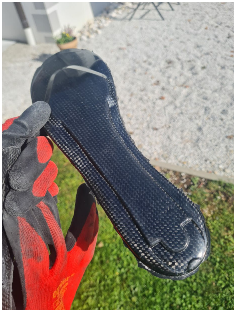
Slika 21: Primer kolesarskega čevlja z jedrom iz spenjenega epoksija (Lastni vir)
