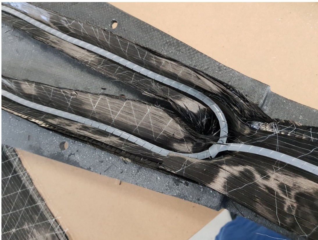
Slika 11: Ogljikova vlakna v kalupu s spiralno cevjo za prenos epoksi smole po izdelku (Lastni vir)
