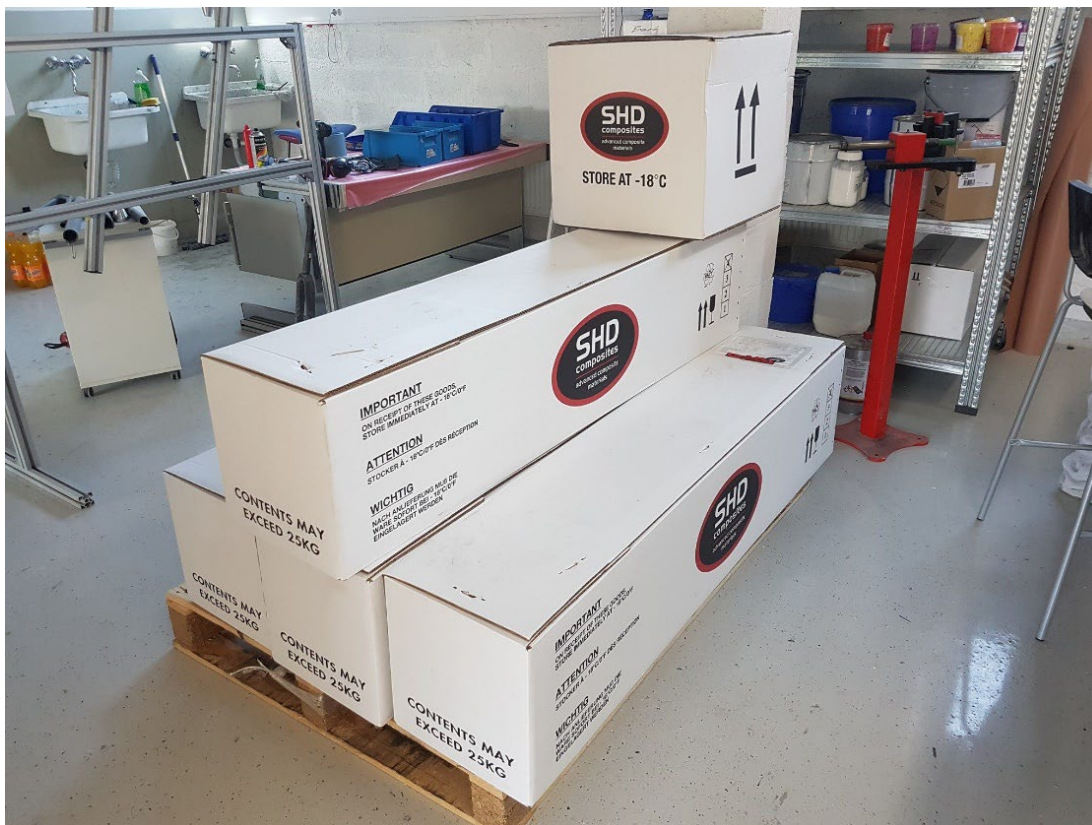
Slika 1: Primer surovine v zabojnikih, shranjeno mora biti pri -18\text{ }^{\circ}\text{C} (Lastni vir)
