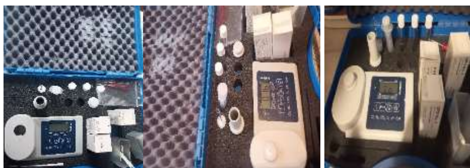
Slika 9: Naprava za merjenje vsebnosti klora v vodovodnem sistemu (Lastni vir)
