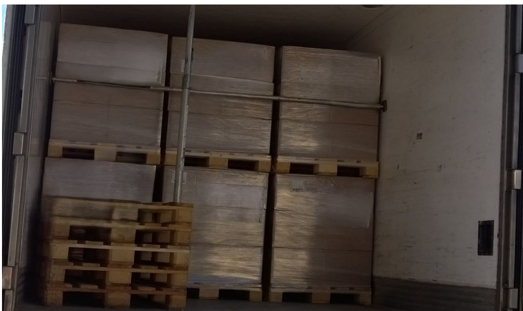
Slika 12: Duple stock naklad v veliko cestno transportno sredstvo (Lastni vir)
