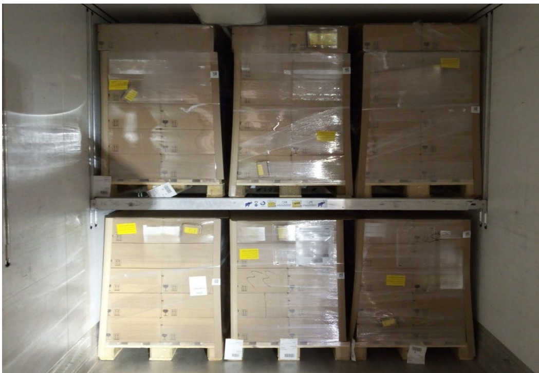
Slika 11: Duple-deck naklad v veliko cestno transportno sredstvo (Lastni vir)
