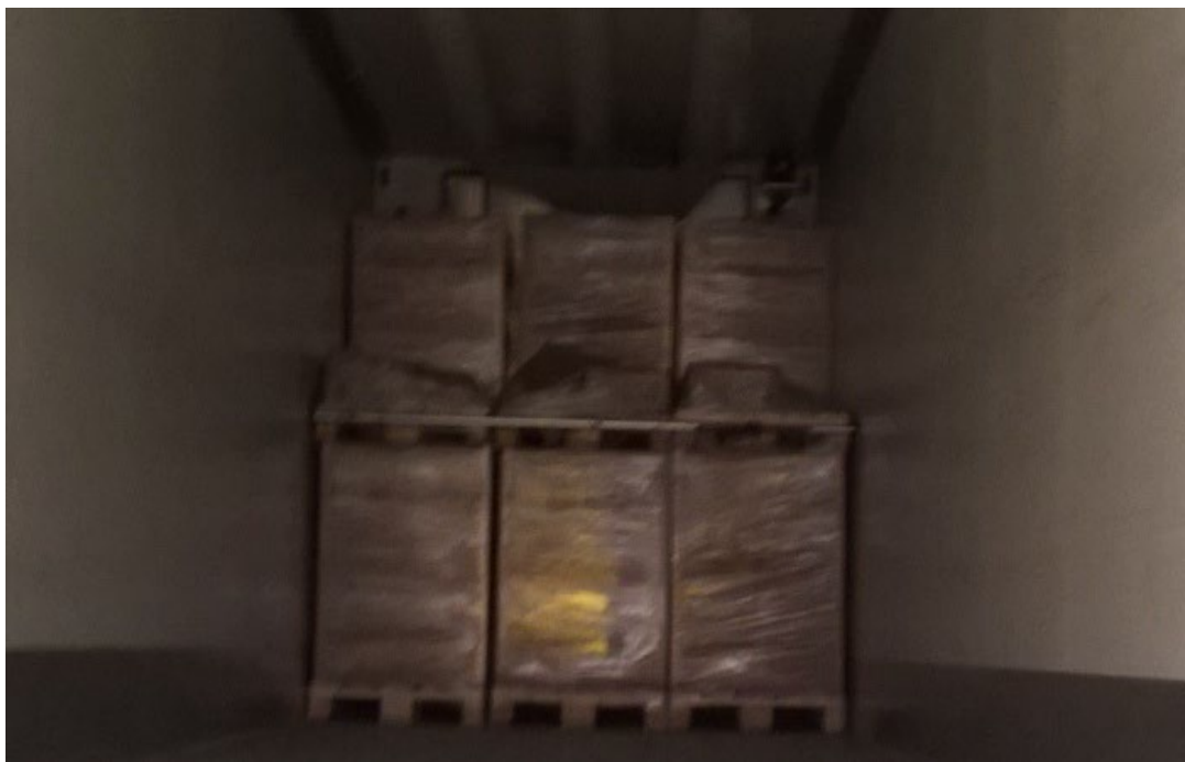
Slika 7: Ustrezno ovito in naloženo blago na cestnem transportnem sredstvu. (Lastni vir)
