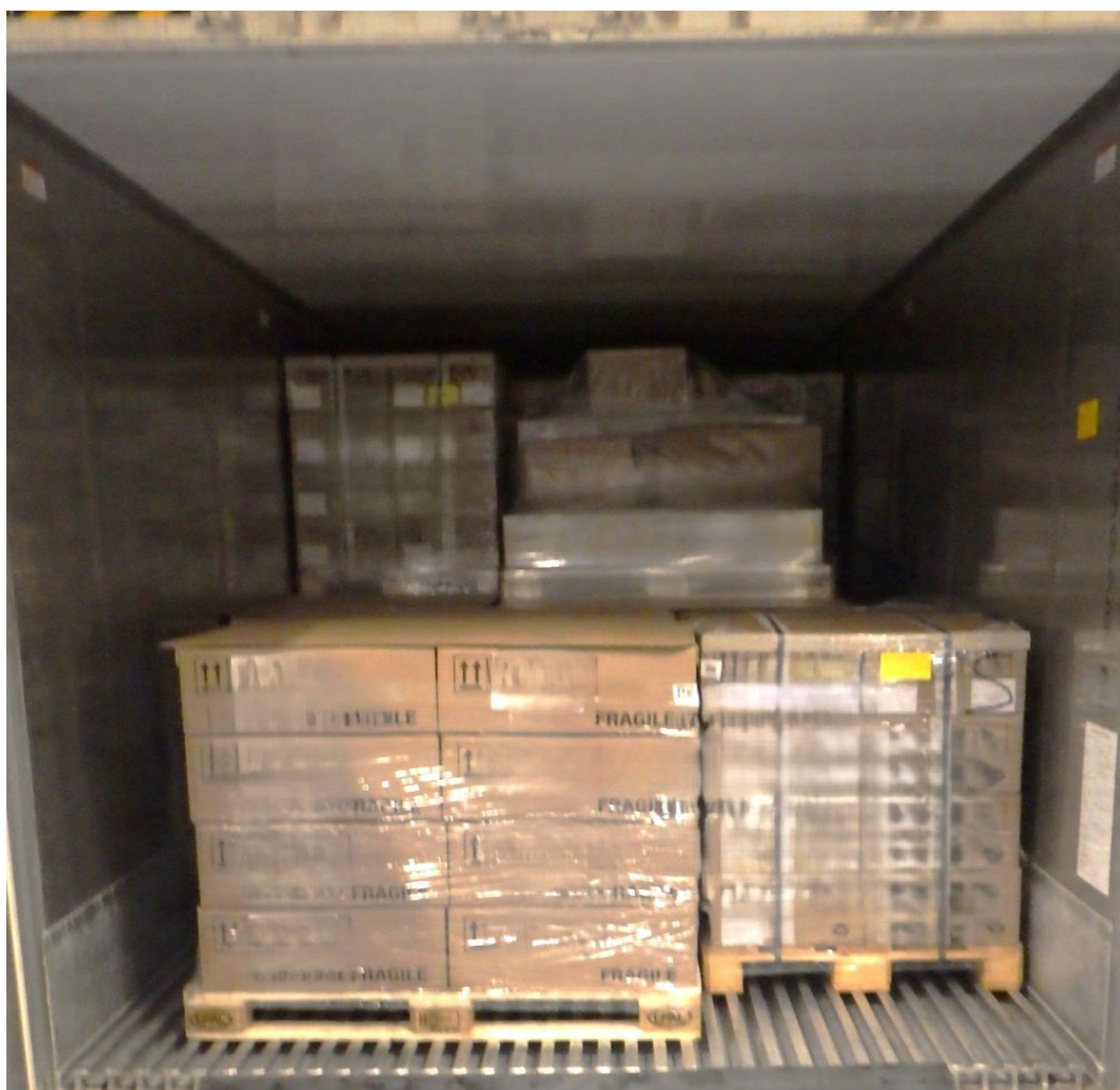
Slika 13: Kombinacija double stock in enojnega naklada v veliko ladijsko hladilno transportno sredstvo (Lastni vir)
