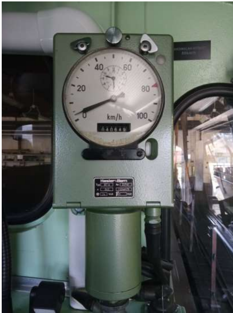
Slika 28: Merilnik hitrosti Hasler RT 9i vgrajen ob prvem krmilnem pultu (Lastni vir)
