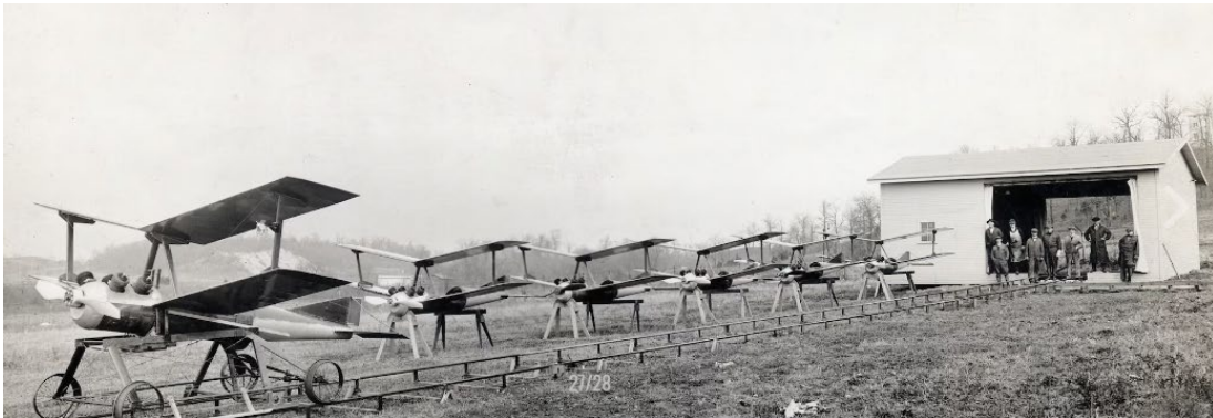
Slika 2: Primer brezpilotnega letala, imenovanega »hrošč« (Vir: National Museum of United States Air Force, 2024)
