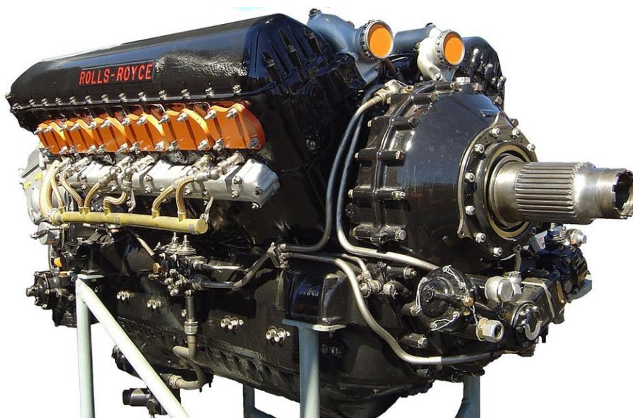
Slika 10: V-motor Rolls Royce Merlin (Wikipedija, 2005)
