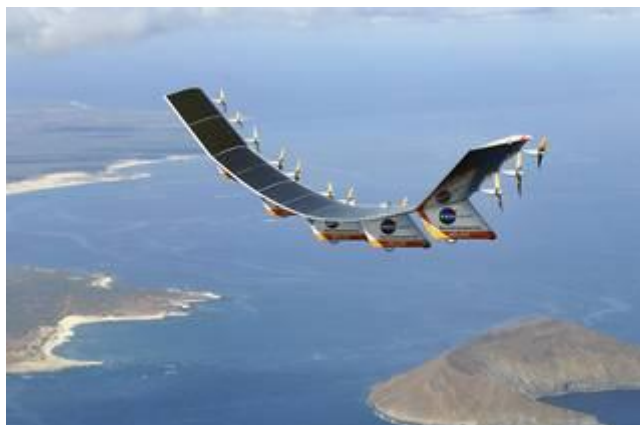
Slika 26: Prikaz poskusnega letala s sončnimi celicami na vrhu kril (Galante, 2003)
