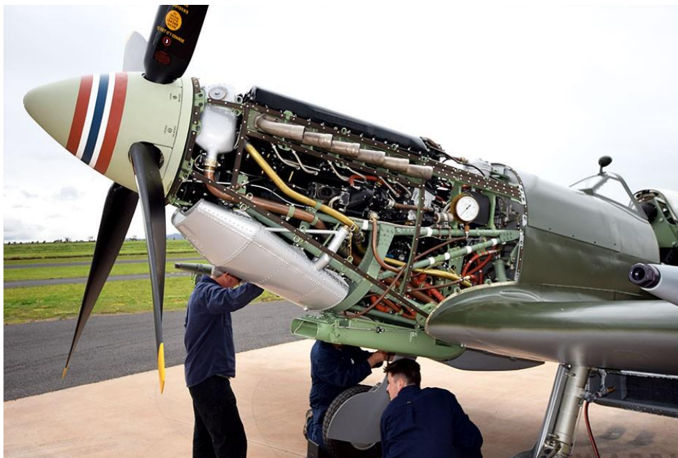
Slika 11: Prikaz V-motorja v letalu (Parker, 2021)
