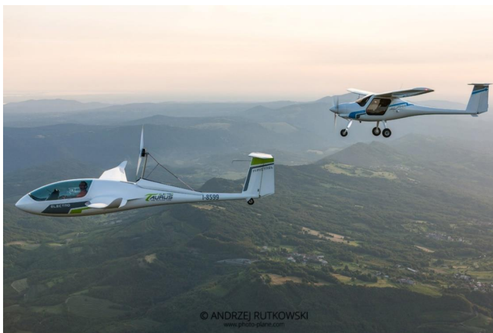
Slika 27: Dve Pipistrelovi letali; prvo je jadralno letalo s pomožnim motorjem, drugo popolno električno letalo. (Rutkowski, b.l.)
