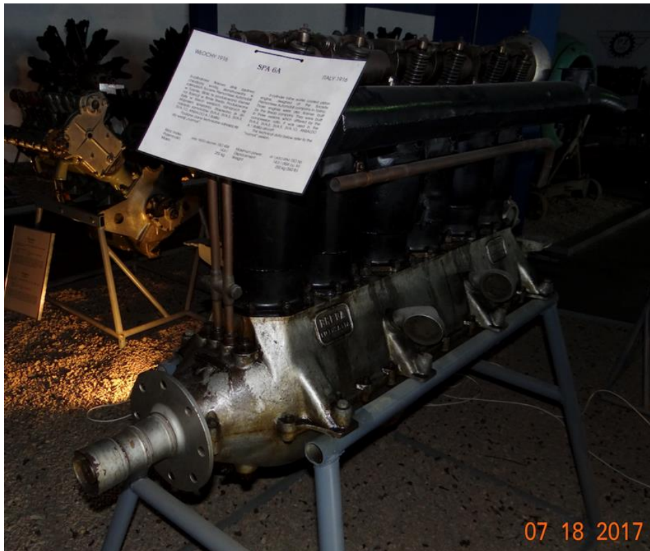
Slika 4: Linijski motor SPA-6A (Hetman, 2017)
