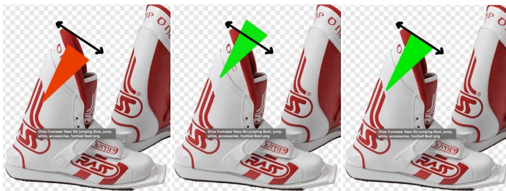
Slika 25: Prvi prikaz prikazuje nepravilno nameščeno zagozdo, ostala dva prikaza z zeleno pa prikazujeta pravilno namestitev in višino v skakalnem čevlju (Vir: Fiski,2020)
