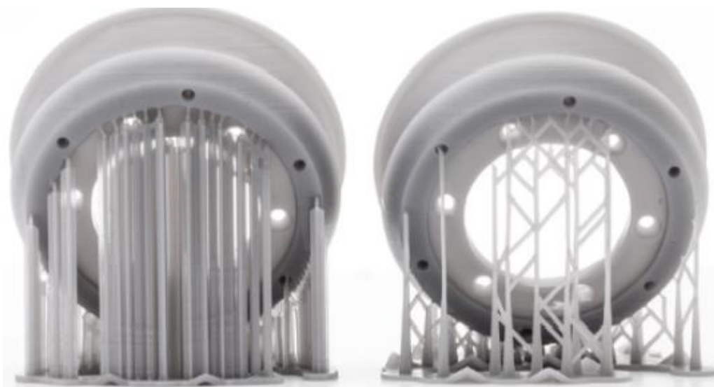
Slika 9: Podporne strukture na tiskanem modelu (Vir: Tehnični priročnik za 3D tiskanje, 2020)
