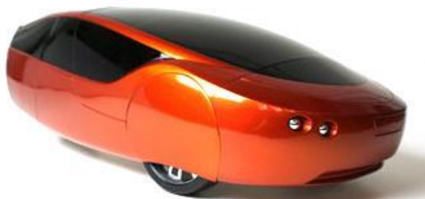
Slika 4: Prvo vozilo, ki je bilo izdelano z dodajalno tehnologijo 3D tiskanja (Vir: 3dprint, 2020)
