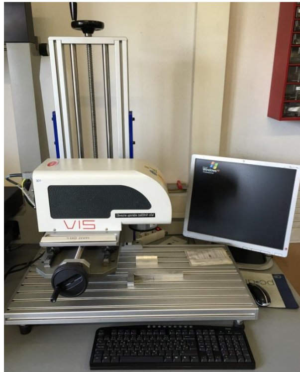
Slika 8: Naprava za graviranje (Lastni vir)
