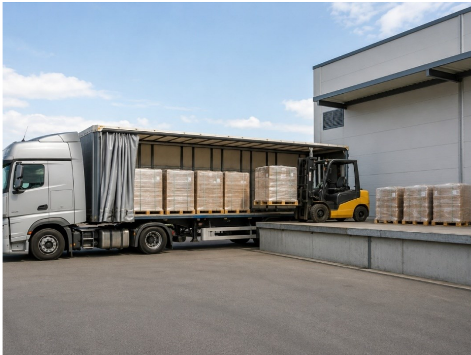
Slika 10: Razklad tovara s stranske rampe kot dejavnik pri načrtovanju razporeditve palet v vozilu (Lastni vir)
