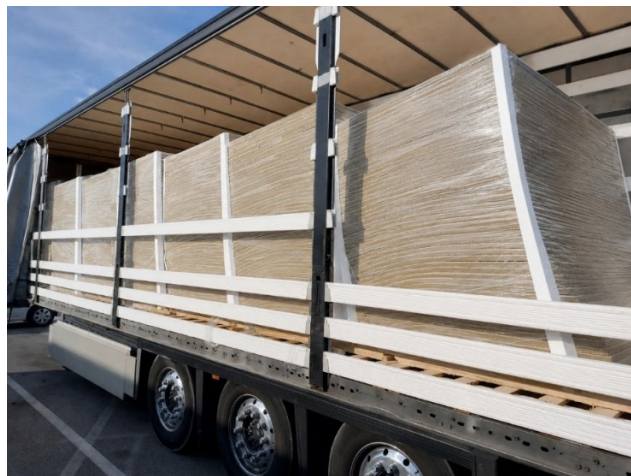
Slika 6: Vpliv neustrezne razporeditve palet na stabilnost tovora v priklopnem vozilu (Lastni vir)
