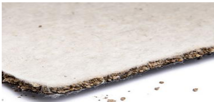
Slika 11: Primer bentonitne polsti (Vir: Sinteza lining, 2021)
