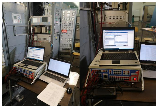
Slika 28: Preizkusi zaščit s preizkusno napravo OMICRON CMC 256-6 (Vir: lasten)
