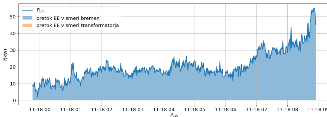
Slika 9: Časovni potek moči P_m na ločilnem mestu l_m za izrez 2 (Vir: Arhiv Elektra Celje)
