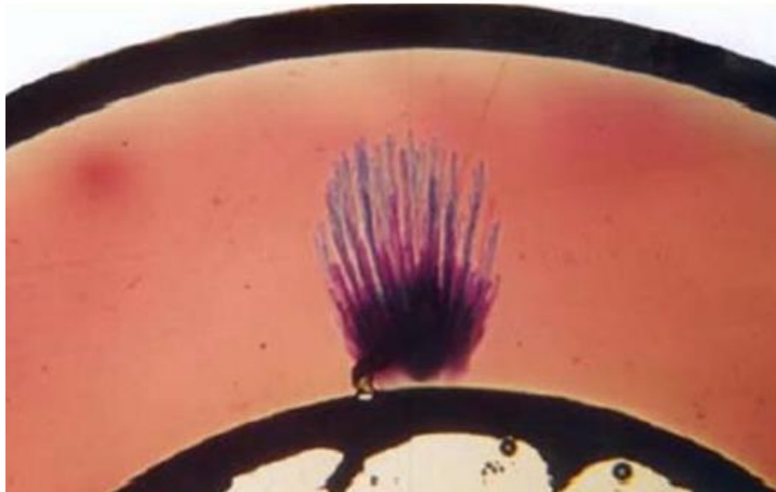
Slika 14: Vodna drevesa v kabelski izolaciji (Vir: CabLab Pty. Ltd., b.l.)
