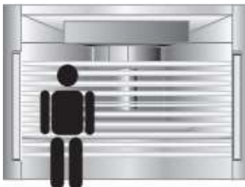
Slika 7: Prikaz delovanja optičnih zaves Leuze
