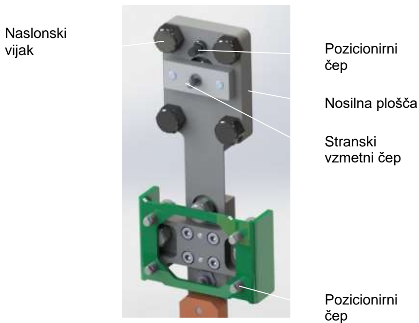
Slika 39: Naslonski del pritrditve kosa 1141533001-1 (Lastni vir)
