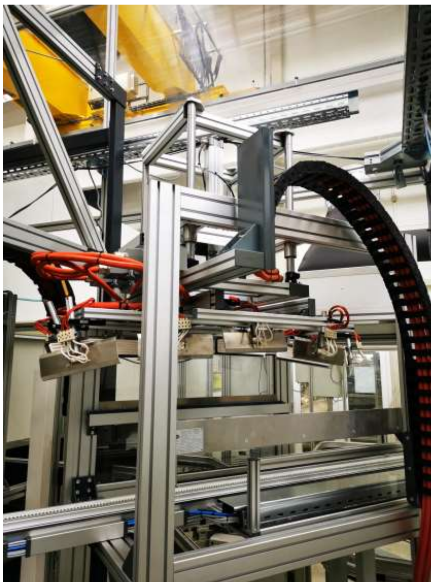
Slika 23: Naprava z grelniki za točkovno segrevanje (Vir: Hella Saturnus Slovenija, 2021–2022)
