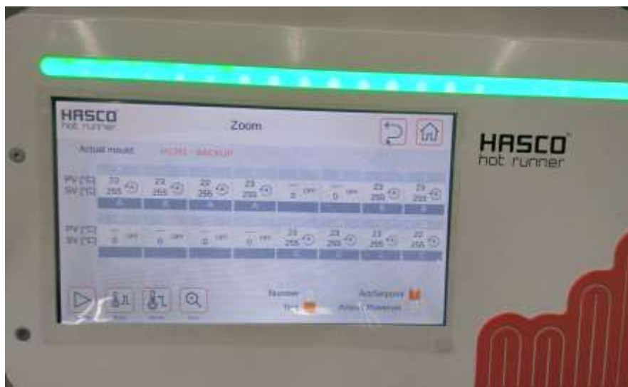
Slika 25: Samostojna enota za nadzor grelnikov (Vir: Hella Saturnus Slovenija, 2021–2022)
