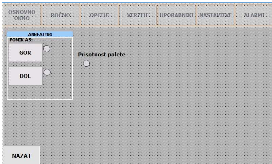
Slika 39: Ročni režim za točkovno segrevanje in prisotnost palete (Lastni vir)
