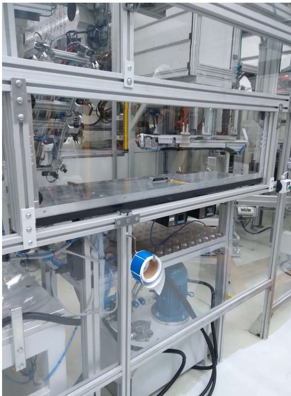
Slika 34: Varnostna vrata za delno samodejni režim (Vir: Hella Saturnus Slovenija, 2021–2022)
