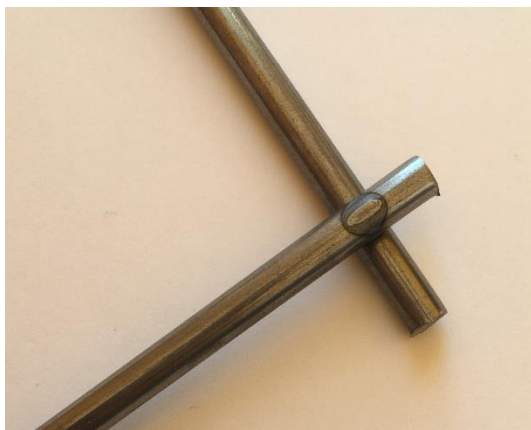
Slika 33: Primer dobrega zvarnega spoja žic debeline 6 mm (Lastni vir)
