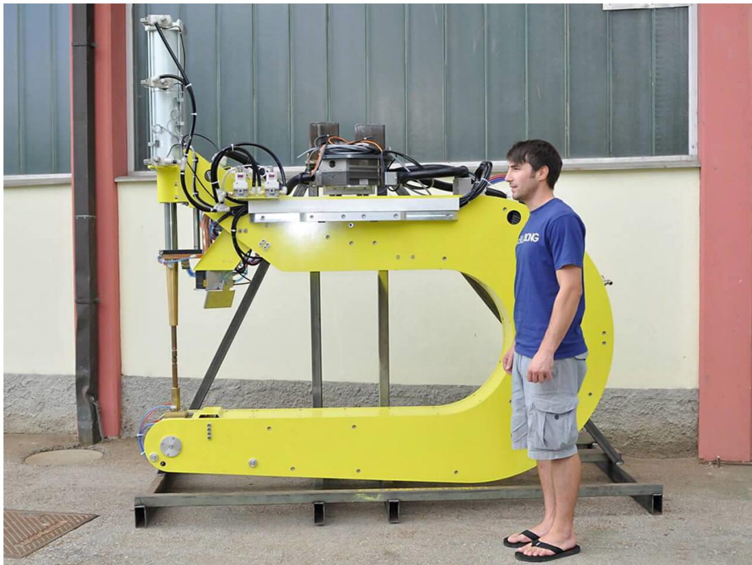
Slika 11: Varilne klešče slovenskega proizvajalca Kočever in sinovi (Vir: kocevar.eu/sl/robotske-klesce-za-uporovno-varjenje)
