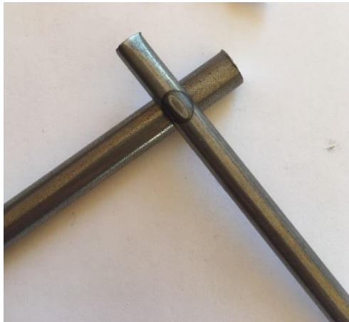
Slika 28: Primer dobrega zvarnega spoja žic debeline 6 mm ter 8 mm (Lastni vir)
