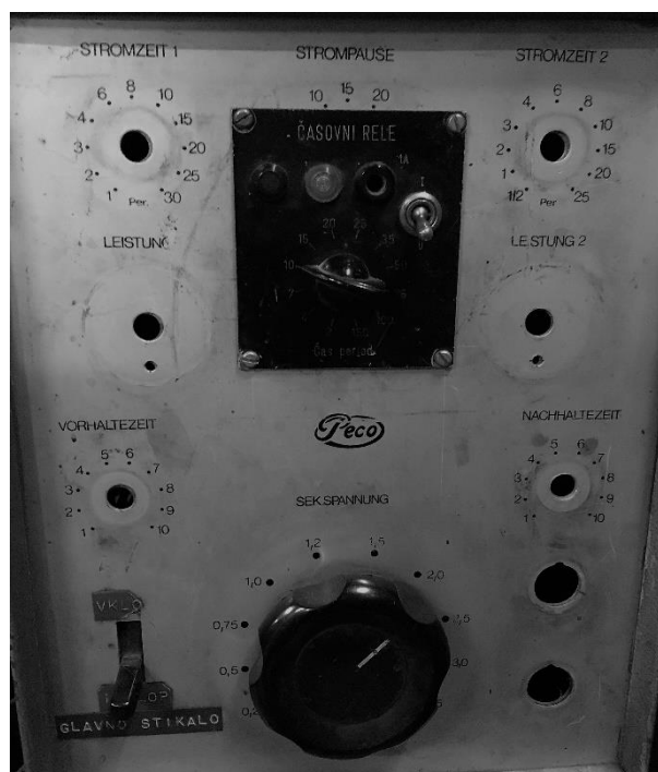
Slika 19: Nadzorna plošča varilnega aparata, s katerim smo varili (Lastni vir)
