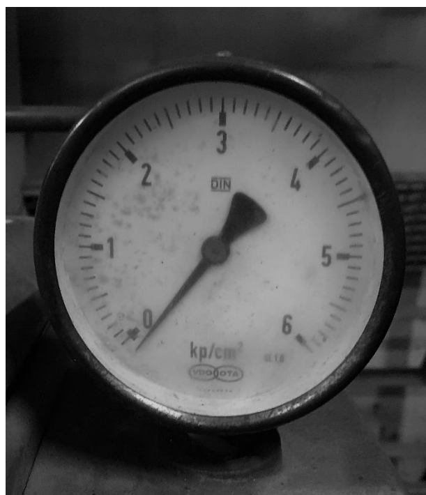
Slika 20: Prikazovalnik tlaka varilnega aparata, ki ga poljubno uravnavamo (Lastni vir)
