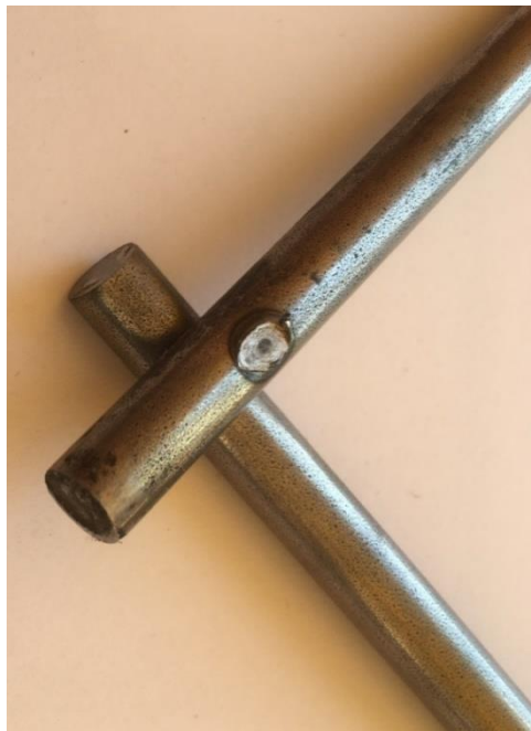
Slika 31: Primer slabega zvarnega spoja žic debeline 10 mm (Lastni vir)
