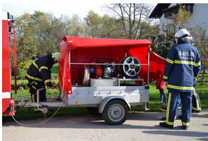
Slika 26: Priklopnik za visokotlačno črpalko (Vir: GZ Brežice, 2019)
