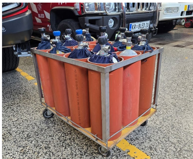
Slika 40: Voziček lastne izdelave za skladiščenje rezervnih tlačnih posod dihalnega aparata (Lastni vir)
