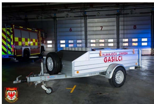
Slika 22: Priklopnik za prevoz lovilne zavesa pri izlitju nevarnih snovi v vodo (Vir: GARS Kranj, 2020e)
