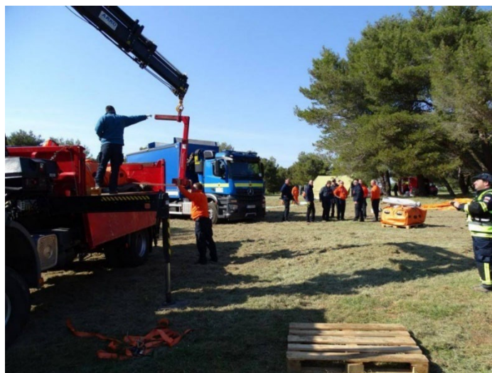
Slika 38: Uporaba hidravličnega avtodvigala pri raztovarjanju opreme (Vir: Uporaba hidravličnega avtodvigala pri raztovarjanju opreme, 2020)
