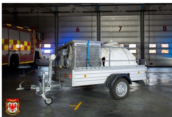
Slika 24: Priklopnik z napihljivo vskočno blazino za reševanje iz višjih nadstropij (Vir: GARS Kranj, 2020g)
