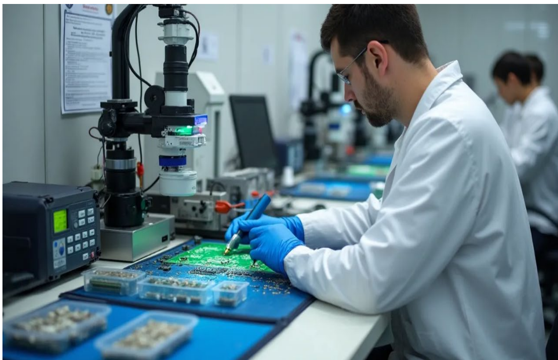
Slika 10: Operater izvaja procesno kontrolo spajkanja komponent na tiskanih vezjih z uporabo ročnega spajkalnika in merilne opreme.
