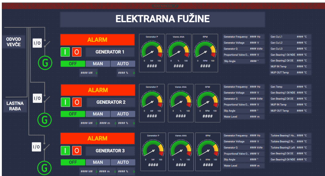
Slika 22: Izdelan vmesnik SCADA za zaslon z resolucijo 2560 pik × 1440 pik (Lastni vir)
