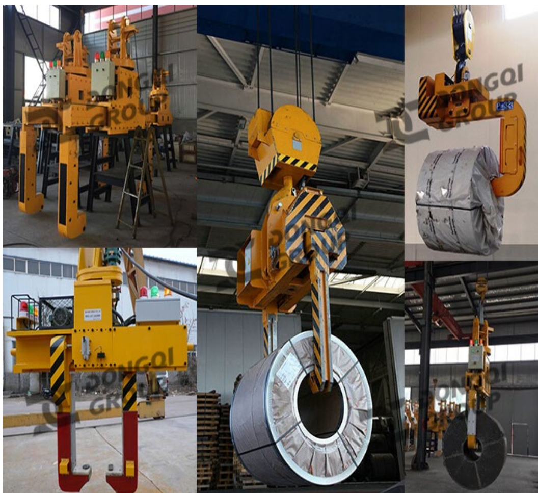
Slika 10: Dvigalo s priključki v obliki črk L in narobe obrnjene črke U (Vir: Craneskit.com, 2019)
