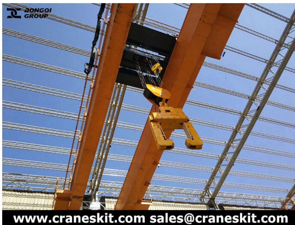
Slika 9: Dvigalo s priključki v obliki narobe obrnjene črke U (Vir: Craneskit.com, 2019)
