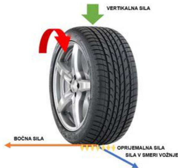
Slika 2: Sile, ki delujejo na avtoplašč (Lastni vir)
