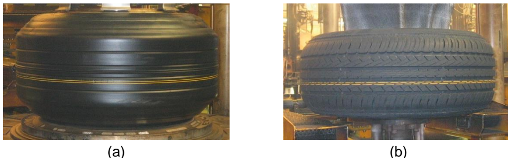
Slika 8: Surovec pred začetkom vulkanizacije (a) in avtoplašč (b) (Vir: Drinovec, 2015)
