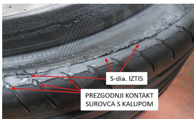
Slika 23: Rezultat »Hot press« testa (S-dia. iztis in prezgodnji kontakt surovca s kalupom) (Vir: Lastni vir)
