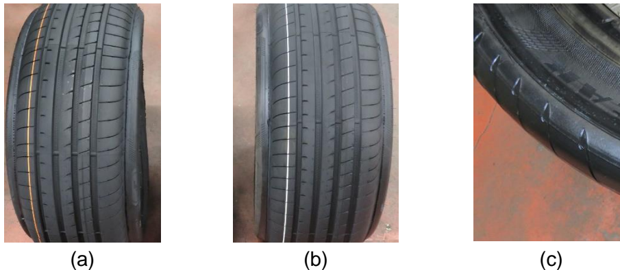
Slika 25: Primerjava S-dia. iztisov na obstoječem avtoplašču (a), avtoplašču s spremenjeno bočnico (b) in status kontakta surovca s kalupom na avtoplašču s spremenjeno bočnico (c) (Vir: Lastni vir)
