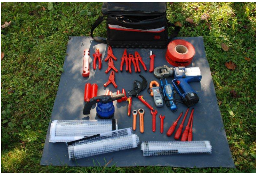
Slika 9: Izolacijsko orodje za izvedbo DPN (Vir: Elektro Ljubljana, 2011a)
