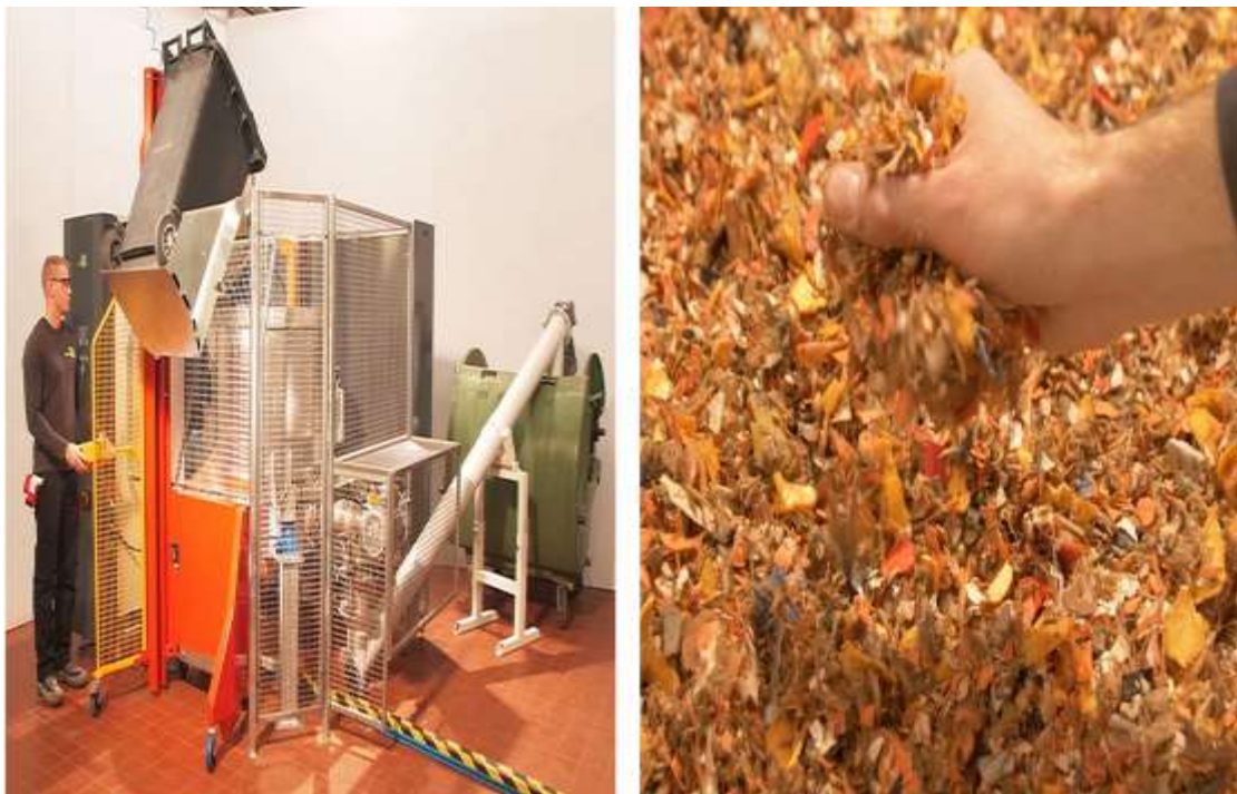
Slika 14: Parni sterilizator z integriranim drobilnikom (Vir: Celitron, 2022)
