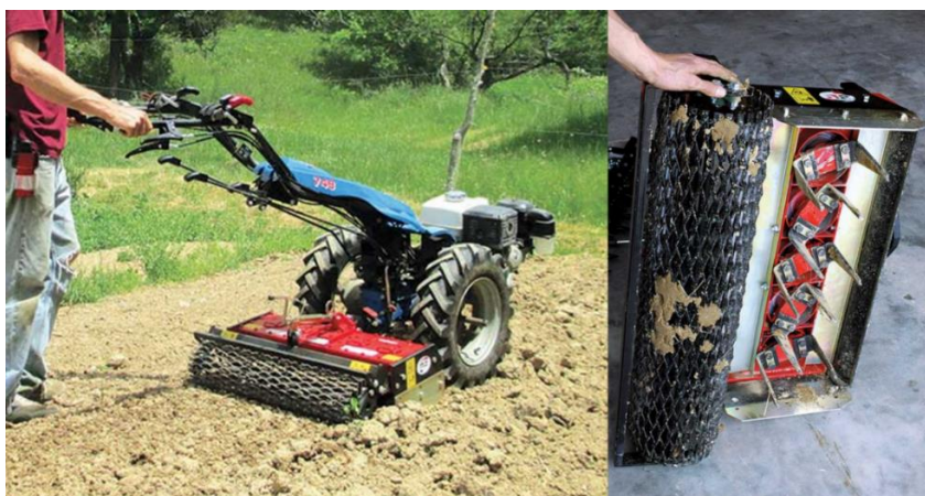
Slika 21: Orodje za oblikovanje gredic s plitko obdelavo tal, namenjeno delu s samohodnim traktorjem. (Vir: Mother Earth News)
