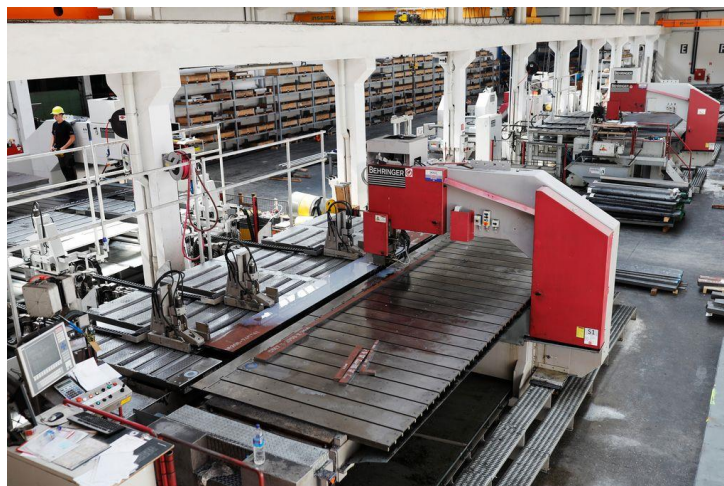
Slika 2: Tračne žage za razrez materiala večjih profilov (Vir: www.damatech.com )
