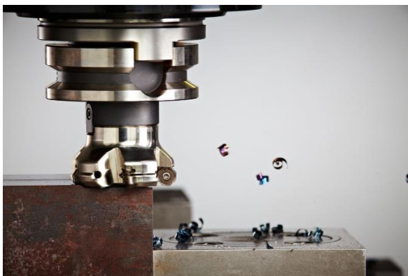
Slika 4: Čelno rezkanje (Vir: www.damatech.com )
