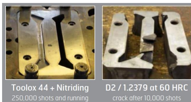
Slika 3.2: Primerjava med jeklom Toolox 44 in jeklom z oznako 1.2379 v aplikaciji (Vir: https://www.ssab.com/products/brands/toolox/toolox-download )
