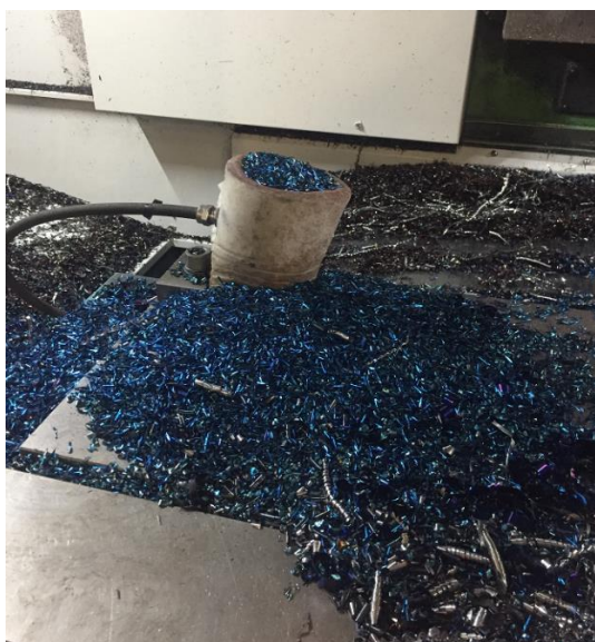
Slika 16: Značilni modri odrezki pri obdelovanju jekla Toolox® 44 (Vir: Lasten)
