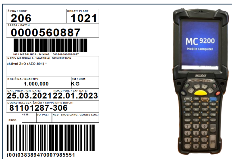
Slika 2: SSCC etiketa in Zebra RF terminal (Vir: Trelleborg Slovenija d. o. o., 2021)
