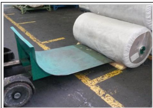
Slika 9: Manipulator tekstilnih zvitkov (Vir: Trelleborg Slovenija d. o. o., 2021)
