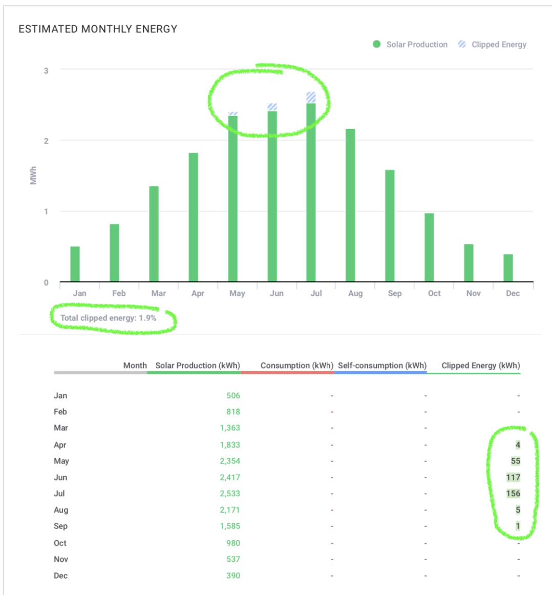
Slika 13: Prikaz izračuna porezane energije (vir: povzeto po SolarEdge technologies, b.l.)
