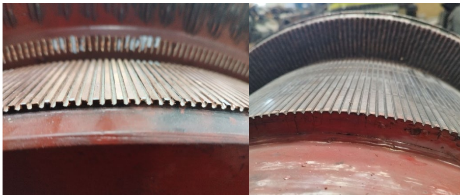
Slika 28: Kolektor VM 363 (levo) in kolektor VM 342 (desno) (Lastni vir)
