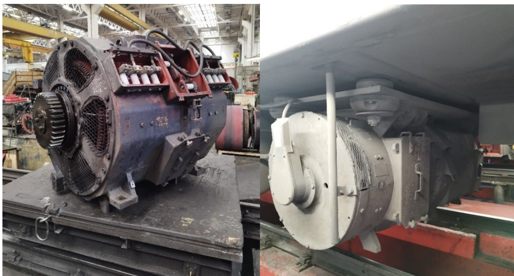
Slika 24: Vlečni motor (levo) in pretvornik (desno) (Lastni vir)
