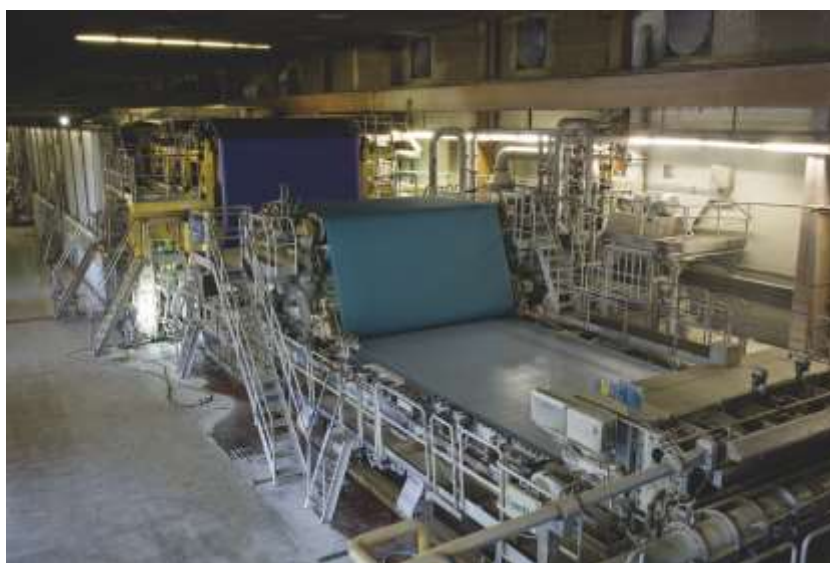
Slika 6: Začetni elementi papirnega stroja
