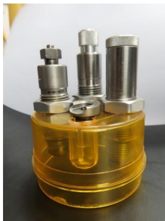
Slika 5: Matrica za kaliber 308 Win
