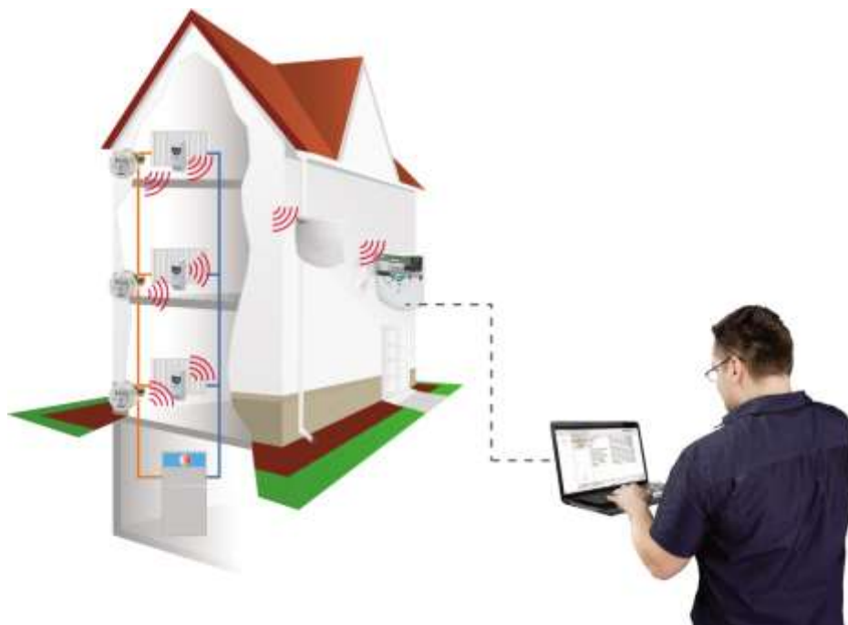
Slika 5: Prikaz odčitavanja v načinu »AMR« (Vir: Enerkon d.o.o., b.l.)
