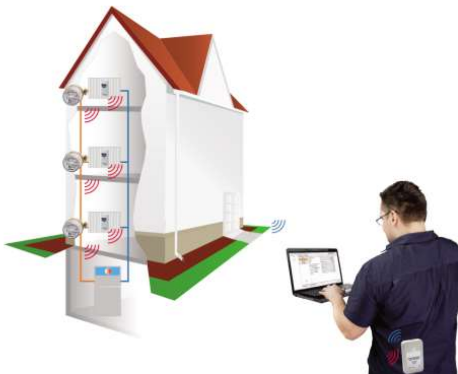
Slika 4: Prikaz odčitavanja v načinu 'walk by' (Vir: Enerkon d.o.o., b.l.)
