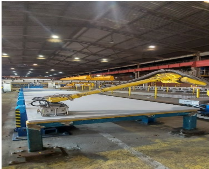
Slika 1: Robotsko označevanje plošče (Vir: Interno gradivo Tehnološki predpis: Označevanje debele pločevine v PDP, 2023)
